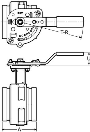
Levier à 10 positions avec butée de réglage
