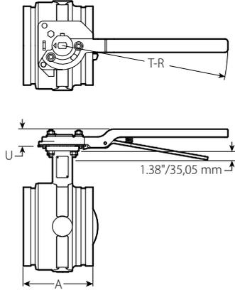
Levier blocable avec butée de réglage
