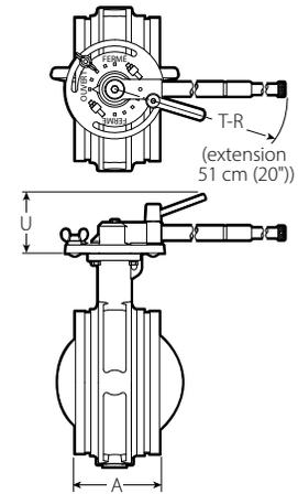
Levier blocable avec butée de réglage
