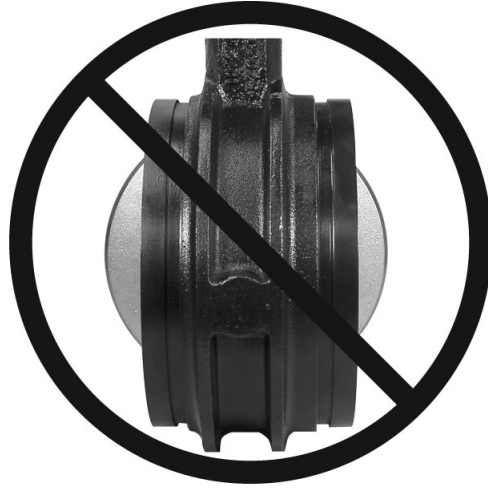
KELEBEK VANALARI, DİSKİ TAM AÇIK KONUMDA OLARAK SİSTEMLERE MONTE ETMEYİN.
