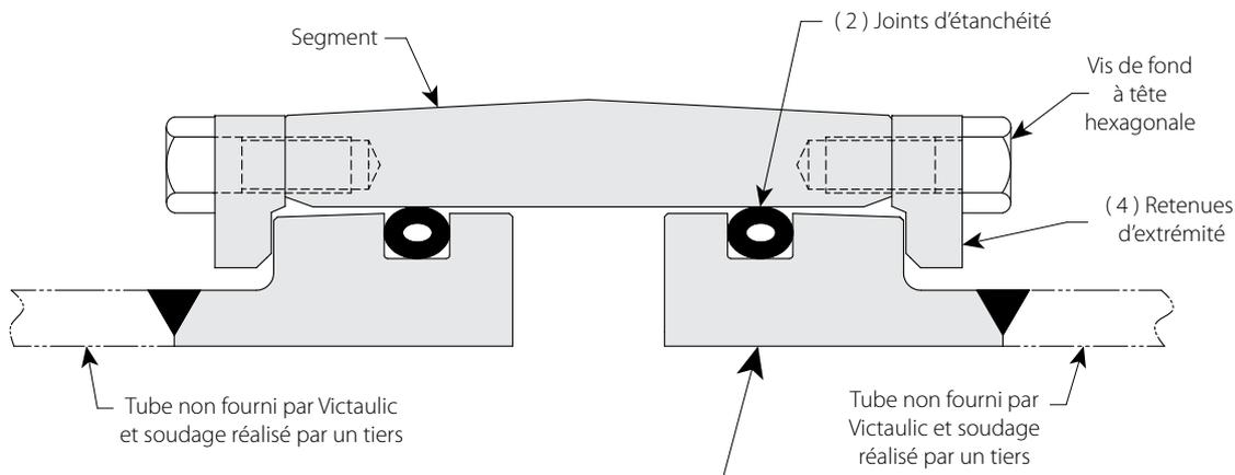
Peut être commandé avec *Vic-ring* qui permet d'assembler des tubes et des raccords de diamètres extérieurs différents. Voir illustration ci-dessous.
