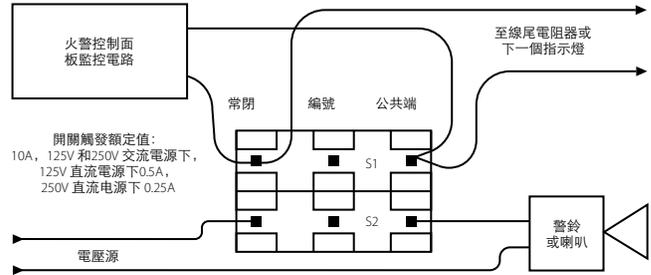
开关 1：每個接線柱 2 根引線
