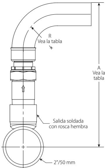
Manguera trenzada Serie AH2-CC con salida ranurada
