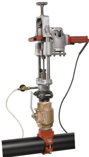
Vic-Tap II开孔工具专为使用 931型 Vic-Tap II Mechanical-T机械三通装置 (920型 Mechanical-T机械三通和 726 系列Vic-Ball球阀的组合) 而设计。Vic-Tap II 能在高达 500 psi/3450 kPa的压力下的碳钢管道系统上开孔。
