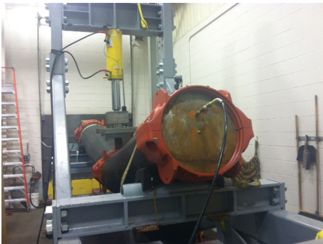
Figura 2. Ensayo de flexión realizado en conjuntos de acoples IPS Victaulic Estilo 908 de 24".
