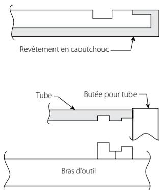
Profil de lame exclusivement réservé à l'abrasion et la corrosion\*
