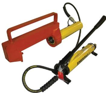
Kleines 10-Tonnen-Hydraulikwerkzeug CTH-01
