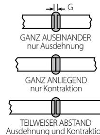
Die an flexiblen genuteten Rohrverbindungen mögliche lineare Bewegung ist unter den Leistungsdaten für jeden Victaulic Kupplungstyp aufgeführt. Dabei handelt es sich um MAXIMALWERTE. Für Planungs- und Installationszwecke sollten diese Zahlen um die folgenden Faktoren reduziert werden, um die Rohrnuttoleranzen zu berücksichtigen.
