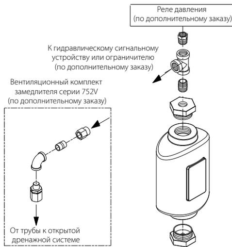
Замедляющая камера должна быть установлена так, как показано на чертежах обвязки аварийной сигнализации.
