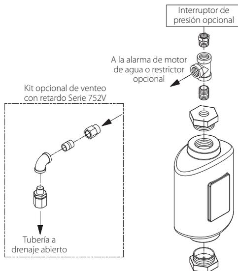
La cámara de retardo se debe instalar como se muestra en los diagramas de la configuración de alarma.
