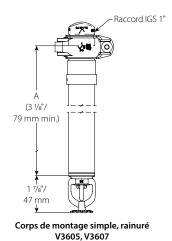
Für Installationen in Nasssystemen oder Trockensystemen/ vorgesteuerten Systemen in Bereichen über 40 °F/5 °C
