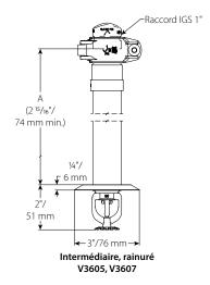
Für Installationen in Nasssystemen oder Trockensystemen/ vorgesteuerten Systemen in Bereichen über 40 °F/5 °C
