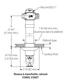
Für Installationen in Nasssystemen oder Trockensystemen/vorgesteuerten Systemen in Bereichen über 40  $^{\circ}\text{F/5}$   $^{\circ}\text{C}$
