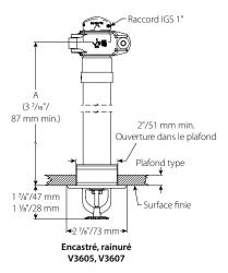
Für Installationen in Nasssystemen oder Trockensystemen/ vorgesteuerten Systemen in Bereichen über 40 °F/5 °C
