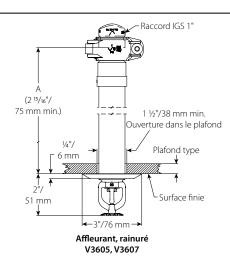
Für Installationen in Nasssystemen oder Trockensystemen/ vorgesteuerten Systemen in Bereichen über 40 °F/5 °C
