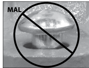
CUELLO OVALADO DEL PERNO ASENTADO INCORRECTAMENTE
