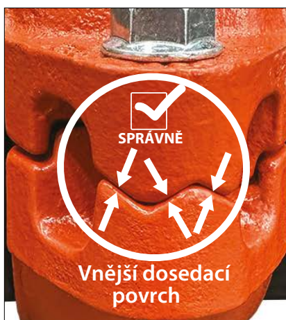
SPRÁVNĚ SESTAVENÝ SPOJ – KONTAKT KOVU NA KOV DLE OZNAČENÍ NA VŠECH VNĚJŠÍCH DOSEDACÍCH PLOCHÁCH
