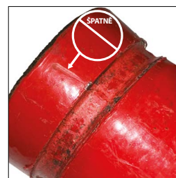
ŠPATNÝ KONEC POTRUBÍ OBSAHUJE VELKÝ VTIISK V NÁTĚRU V ROZMĚRU „A“
