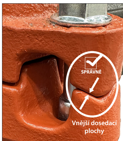
SPRÁVNĚ SESTAVENÝ SPOJ – KONTAKT KOVU NA KOV DLE OZNAČENÍ NA VŠECH VNĚJŠÍCH DOSEDACÍCH PLOCHÁCH
