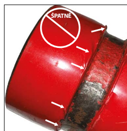
ŠPATNÝ KONEC TRUBKY OBSAHUJE SVRAŠTĚLOU/ZVLNĚNOU BARVU NA ROZMĚRU „A“
