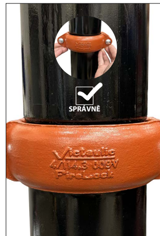
FOTOGRAFIE 4 (PŘIJATELNÉ) – PERA TĚLESA JSOU ZAROVNÁNA S DRÁŽKAMI TRUBKY
