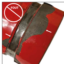
SLECHT HET UITEINDE VAN DE LEIDING VERTOONT ERNSTIGE AFLBLADERING VAN DE VERF OP DE "A"-AFMETING
