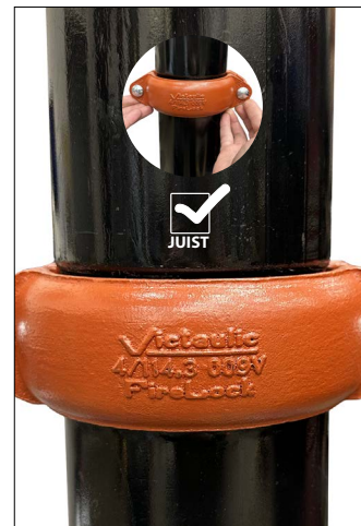
FOTO 4 (ACCEPTEBEL) – DE SPIEËN VAN DE BEHUIZINGEN LIGGEN IN LIJN MET DE GROEVEN VAN DE LEIDING
