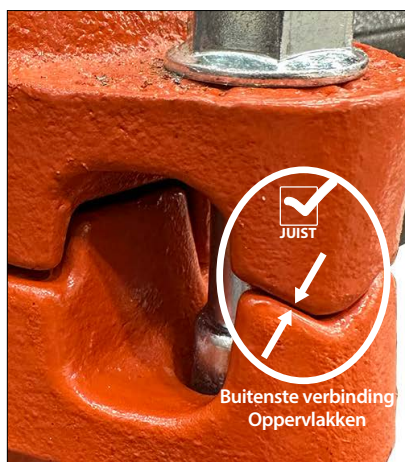
CORRECT GEMONTEERDE VERBINDING – METAAL-OP-METAAL-CONTACT ZOALS AANGEGEVEN OP ALLE BUITENSTE AANSLUITVLAKKEN
