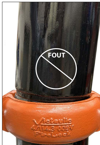
FOTO 1 (ONACCEPTEBEL) – TE GROTE INBRENGHOEK
