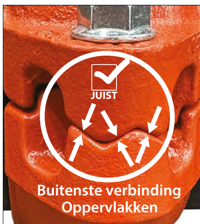
CORRECT GEMONTEERDE VERBINDING – METAAL-OP-METAAL-CONTACT ZOALS AANGEGEVEN OP ALLE BUITENSTE AANSLUITVLAKKEN
