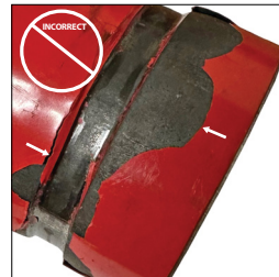
INCORRECT L'EXTRÉMITÉ DU TUYAU PRÉSENTE DES ÉCLATS IMPORTANTS DE PEINTURE SUR LA DIMENSION « A »
