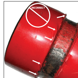
INCORRECT L'EXTRÉMITÉ DU TUYAU PRÉSENTE UNE PEINTURE ONDULÉE/PLISSÉE SUR LA DIMENSION « A »
