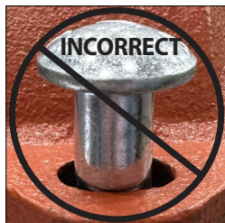
COLLET OBLONG DU BOULON MIS EN PLACE DE FAÇON INCORRECTE
