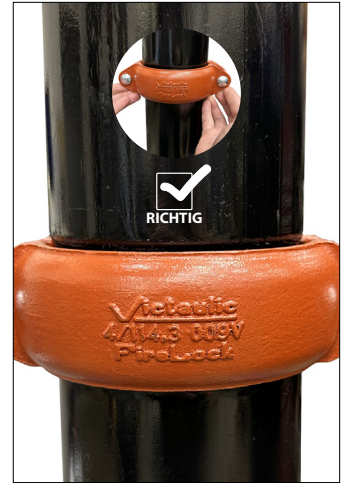
FOTO 4 (ZULÄSSIG) – GEHÄUSEKEILE SIND AUF DIE ROHRNUTEN AUSGERICHTET
