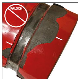
FALSCH DAS ROHRENDE WEIST STARK ABGEBLÄTTERTEN LACK AN ABMESSUNG „A“ AUF
