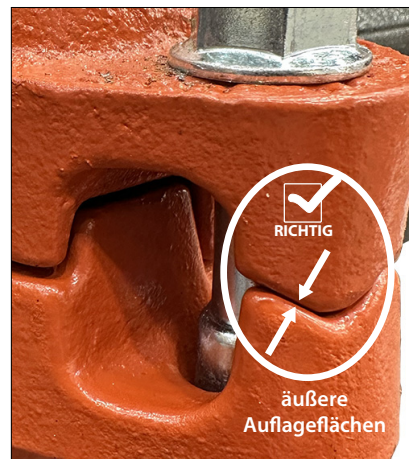
RICHTIG MONTIERTE VERBINDUNG – KONTAKT VON METALL AUF METALL WIE GEZEIGT AN ALLEN ÄUSSEREN AUFLAGEFLÄCHEN
