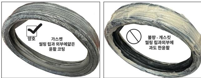
5. **Style 009V 커플링의 재조립을 위해 가스켓 윤활:** 가스켓 씰링 립과 외부에 호환 가능한 윤활제를 얇게 도포합니다. 2페이지의 "가스켓용 윤활제 호환성" 표를 참조하십시오.
