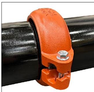
**4. 조인트를 조립합니다.** 체결 부품의 그루브 끝단을 각각의 커플링 개구부에 삽입하여 조인트를 조립합니다. 그루브가 있는 체결 부품의 끝단이 가스켓의 중간 다리에 닿을 때까지 커플링에 삽입합니다.
