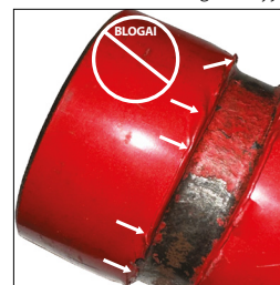
BLOGAI VAMZDŽIO GALE MATOMAS NELYGUS/BANGUOTAS DAŽŲ SLUOKSNIS „A“ MATMENS SRITYJE
