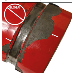
BLOGAI VAMZDŽIO GALE MATOMAS STIPRIAI NUSILUPĘS DAŽŲ SLUOKSNIS „A“ MATMENS SRITYJE
