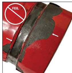
FEIL RØRENDEN HAR ALVORLIG AVSKALET LAKK PÅ "A"-DIMENSJONEN
