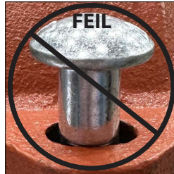
OVAL KRAGE PÅ BOLTEN PLASSERT FEIL
