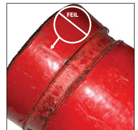
FEIL RØRENDEN HAR EN STOR BULK I LAKKEN PÅ "A"-DIMENSJONEN
