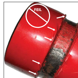
FEIL RØRENDEN HAR RUGLETE/ BØLGET LAKK PÅ "A"-DIMENSJONEN
