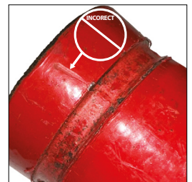
INCORECT CAPĂTUL ȚEVII PREZINTĂ O ADÂNCITURĂ MARE ÎN VOPSEA PE DIMENSIUNEA „A”
