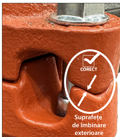
RACORD ASAMBLAT CORECT – CONTACT METAL PE METAL, ASTFEL CUM ESTE INDICAT, PE TOATE SUPRAFEȚELE DE ÎMBINARE EXTERIOARE
