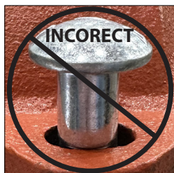
GĂTUL OVAL AL ȘURUBULUI NEAȘEZAT NECORESPUNZĂTOR
