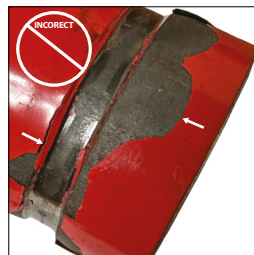
INCORECT CAPĂTUL ȚEVII PREZINTĂ VOPSEA EXFOLIATĂ PUTERNIC PE DIMENSIUNEA „A”
