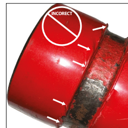
INCORECT CAPĂTUL ȚEVII PREZINTĂ VOPSEA STRĂNSĂ/ ONDULATĂ PE DIMENSIUNEA „A”
