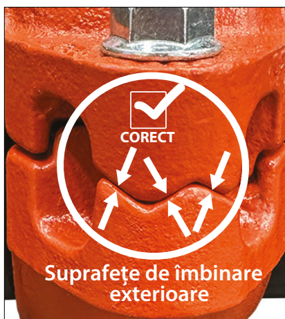
RACORD ASAMBLAT CORECT – CONTACT METAL PE METAL, ASTFEL CUM ESTE INDICAT, PE TOATE SUPRAFEȚELE DE ÎMBINARE EXTERIOARE
