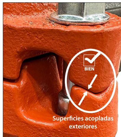
UNIÓN CORRECTAMENTE ENSAMBLADA – CONTACTO METAL CON METAL COMO SE INDICA EN TODAS LAS SUPERFICIES ACOPLADAS EXTERIORES
