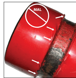
MAL EL EXTREMO DE LA TUBERÍA CONTIENE PINTURA ARRUGADA/ ONDULADA EN LA DIMENSIÓN "A"
