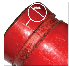
MAL EL EXTREMO DE LA TUBERÍA CONTIENE UNA GRAN ABOLLADURA EN LA PINTURA EN LA DIMENSIÓN "A"
