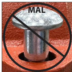
CUELLO OVAL DEL PERNO ASENTADO INCORRECTAMENTE
