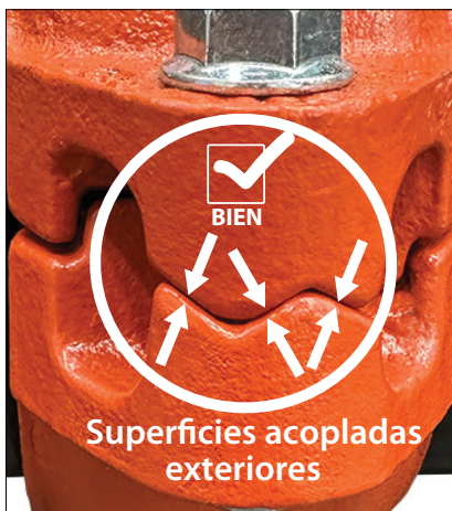
UNIÓN CORRECTAMENTE ENSAMBLADA – CONTACTO METAL CON METAL COMO SE INDICA EN TODAS LAS SUPERFICIES ACOPLADAS EXTERIORES
