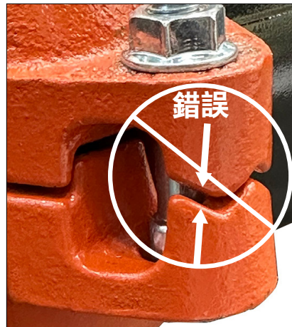
正確組裝的接頭 ——所有外部配合面處均應有金屬與金屬的接觸 註：內部表面不會有金屬與金屬接觸請參閱上一頁。
