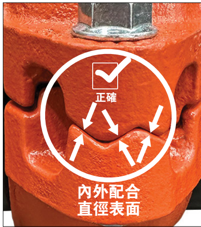
正確組裝的接頭 ——所有外部配合面處均應有金屬與金屬的接觸 註：內部表面不會有金屬與金屬接觸請參閱上一頁。
