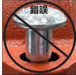
螺栓橢圓頭 錯誤放置
