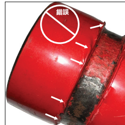
壞 管端 “A” 尺寸範圍內的油漆嚴重剝落
