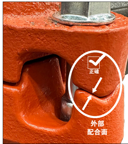
正確組裝的接頭 ——所有外部配合面處均應有金屬與金屬的接觸 註：內部表面不會有金屬與金屬接觸請參閱上一頁。
