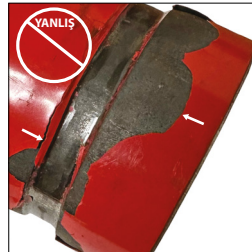
KÖTÜ BORU UCU, "A" BOYUTUNDA CİDDİ ŞEKİLDE SOYULMUŞ BOYA İZLERİ İÇERİR
