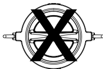
Foute oriëntatie voor horizontale installatie
