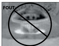
OVALE NEK VAN BOUT NIET CORRECT AANSLUITEND
