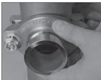
**5. ÜBERPRÜFEN SIE DEN EINGRIFF DES POSITIONIERUNGSRINGS:** Vergewissern Sie sich, dass der Positionierungsring richtig in die Auslassöffnung eingreift. Überprüfen Sie diesen Eingriff durch Rütteln an der oberen (Auslass)-Gehäusehälfte in der Auslassöffnung. **HINWEIS:** Die obere (Auslass)-Gehäusehälfte muss bündig mit dem Rohr-AD sein und darf sich nicht drehen können.
