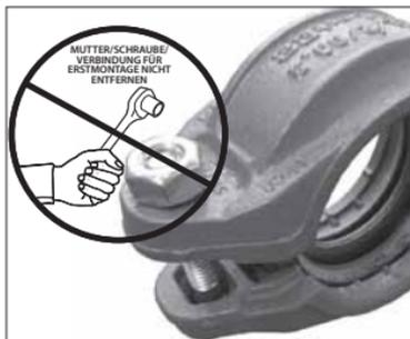
**1. NEHMEN SIE DIE KUPPLUNG NICHT AUSEINANDER:** Starre FireLock™ Installation-Ready™ Kupplungen des Typs 108 und 109 sind so konzipiert, dass der Monteur zur Erstinstallation keine Muttern, Schrauben oder Verbindungen entfernen muss. Dies erleichtert die Installation, da der Monteur das genutete Ende der Gegenstücke direkt in die Kupplung einführen kann.
