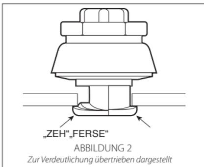
**5. POSITIONIEREN SIE DEN TYP 923 ODER 924:** Bewegen Sie den Typ 923 oder 924, um die „Ferse“ im Rohr zu positionieren. **HINWEIS:** Die Ferse muss wie in Abbildung 2 oben positioniert werden, um die ordnungsgemäße Leistung unter Betriebsbedingungen sicherzustellen.
