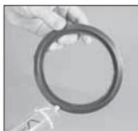
**3. SCHMIEREN SIE DIE FLANSCHDICHTUNG:** Tragen Sie eine dünne Schicht eines verträglichen Schmiermittels auf die Dichtlippen und die Außenseite der Flanschdichtung auf. Siehe die Tabelle „Schmiermittelkompatibilität für Dichtungen“ in diesem Handbuch. **HINWEIS:** Diese Flanschdichtung ist als alleinige Abdichtung vorgesehen. Beachten Sie jedoch für Sonderanwendungen den Abschnitt „Hinweise zu Victaulic Flanschscheiben“ auf Seite 201.
