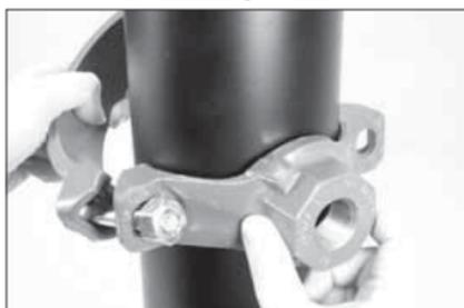
**4. BRINGEN SIE DIE GEHÄUSEHÄLFTEN AN:** Drehen Sie die untere Gehäusehälfte, so dass sie wie oben abgebildet in einem Winkel von ca. 90° zur oberen (Auslass)-Gehäusehälfte steht. Der Positionierungsring der oberen (Auslass)-Gehäusehälfte muss in die Auslassöffnung gesetzt werden. Schwenken Sie die untere Gehäusehälfte um das Rohr herum.
