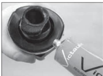
**3b. SCHMIEREN SIE DIE DICHTUNG:** ENTFERNEN SIE NICHT DIE DICHTUNG VOM TYP 923 ODER 924. Tragen Sie eine dünne Schicht eines verträglichen Schmiermittels NUR auf die freiliegende Dichtfläche der Dichtung auf. Siehe die Tabelle „Schmiermittelkompatibilität für Dichtungen“ auf Seite 34.
