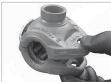
**6a. BRINGEN SIE DIE ZWEITE GEHÄUSEHÄLFTE UND DIE VERBINDUNG AN:** Bringen Sie die zweite Gehäusehälfte an. Vergewissern Sie sich, dass die Dichtung in den Aussparungen der Gehäusehälften sitzt. Bringen Sie die Verbindung wie links abgebildet an den Gehäusehälften an.
