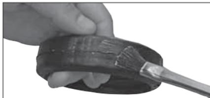
5. **SCHMIERN SIE ZUM WIEDERZUSAMMENBAU VON KUPPLUNGEN DES TYP 108 und 109 DIE DICHTUNG:** Tragen Sie eine dünne Schicht eines verträglichen Schmiermittels auf die Dichtlippen und das Äußere der Dichtung auf. Siehe die Tabelle „Schmiermittelkompatibilität für Dichtungen“ auf Seite 34.
