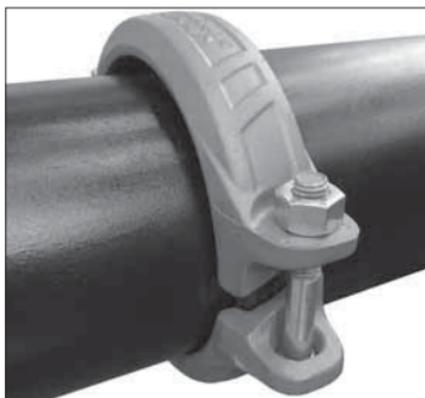
**5. STELLEN SIE DIE VERBINDUNG HER:** Stellen Sie die Verbindung her, indem Sie das genutete Ende eines Gegenstücks in jede Öffnung der Kupplung einführen. Die genuteten Gegenstückenden müssen so weit in die Kupplung eingeführt werden, bis sie mit dem Mittelsteg der Dichtung in Kontakt sind.
