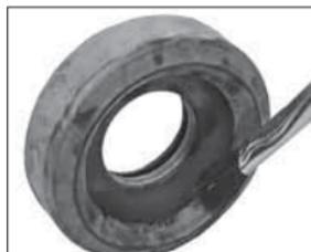
5. **SCHMIERN SIE DIE DICHTUNG ZUM WIEDERZUSAMMENBAU:** Tragen Sie wie oben gezeigt eine dünne Schicht eines verträglichen Schmiermittels auf die Oberflächen der Dichtung auf. Siehe die Tabelle „Schmiermittelkompatibilität für Dichtungen“ auf Seite 34.
