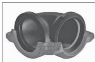
3. **INSTALLIEREN SIE DIE DICHTUNG IN DER ERSTEN FORMTEILGEHÄUSEHÄLFTE:** Legen Sie die Dichtung in eine der Gehäusehälften ein. Vergewissern Sie sich dabei, dass die Enden der Dichtung wie links gezeigt in den Aussparungen des Gehäuses sitzen.
