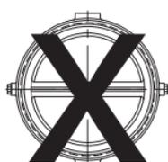
Falsche Ausrichtung für horizontale Montage
