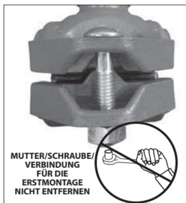
**1. NEHMEN SIE DIE KUPPLUNG NICHT AUSEINANDER:** FireLock™ IGS™ Installation-Ready™ Auslasskupplungen des Typs 118 sind so konzipiert, dass der Monteur zur Erstinstallation keine Muttern, Schrauben oder Verbindungen entfernen muss. Dies erleichtert die Installation, da der Monteur das genutete Ende der Gegenstücke direkt in die Kupplung einführen kann.
