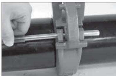
2. Rasten Sie die „T“-Stange des Montagewerkzeugs Typ 792 in die Mulden mit dem längeren Stift (nicht die Seite „im Gusszustand“) ein. Rasten Sie die Nase des Werkzeugs in der mittleren Mulde ein. Drücken Sie das Werkzeug nach unten, bis es auf das Gehäuse trifft. Halten Sie das Werkzeug in dieser Position.
