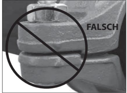
Führen Sie eine Sichtprüfung der Auflageflächenposition an jeder Verbindung durch, um sich zu vergewissern, dass am Umkreis der Auflagefläche (ungefähr zwischen den zwei im Gehäuse eingegossenen Sätzen von Anzeigepfeilen) Metall auf Metall trifft.
