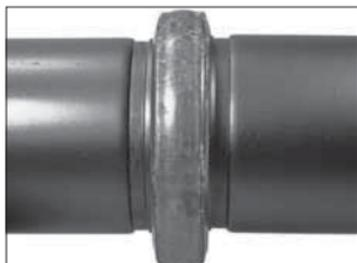
**3. VERBINDEN SIE DIE GEGENSTÜCKE:** Richten Sie die Mittellinien der beiden genuteten Gegenstückenden aufeinander aus. Führen Sie das andere Gegenstückende in die Dichtung ein, bis es den Mittelsteg der Dichtung berührt. **HINWEIS:** Vergewissern Sie sich, dass kein Teil der Dichtung in die Nut eines der Gegenstücke hineinragt.
