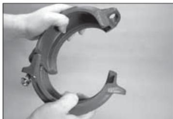
**2. ZUR ERLEICHTERUNG DER MONTAGE:** Eine Schraube kann mit einer lose auf die Schraube gedrehten Mutter in die Gehäusehälften eingeführt werden, damit die Hälften wie gezeigt um das Rohr gelegt werden können. **HINWEIS:** Die Mutter darf nur so weit gedreht werden, dass sie mit dem Ende der Schraube bündig ist.
