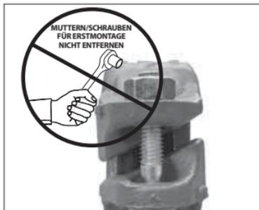
**1. NEHMEN SIE DIE KUPPLUNG NICHT AUSEINANDER:** Die FireLock EZ™ Installation-Ready™ Reduzierkupplungen des Typs 115 sind so konzipiert, dass der Monteur die Muttern und Schrauben für die Installation nicht entfernen muss. Dies erleichtert die Installation, da der Monteur das genutete Ende der Gegenstücke direkt in die Kupplung einführen kann.
