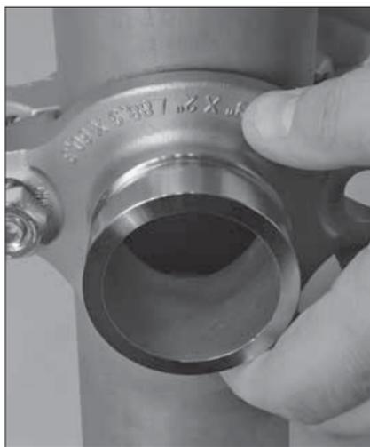
**4. BRINGEN SIE DIE GEHÄUSEHÄLFTEN AN:** Drehen Sie die untere Gehäusehälfte, so dass sie wie oben abgebildet in einem Winkel von ca. 90° zur oberen (Auslass)-Gehäusehälfte steht. Der Positionierungsring der oberen (Auslass)-Gehäusehälfte muss in die Auslassöffnung gesetzt werden. Schwenken Sie die untere Gehäusehälfte um das Rohr herum.
