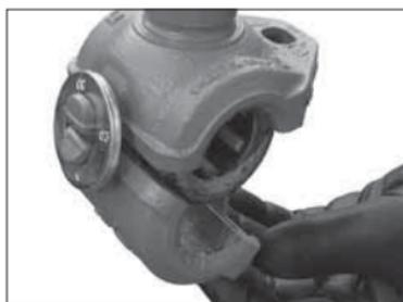
**6. BRINGEN SIE DIE DICHTUNG IM AUSLASSGEHÄUSE AN:** Bringen Sie die Dichtung im Auslassgehäuse an. Vergewissern Sie sich, dass der Auslass des Gehäuses in den Auslassteil der Dichtung eingreift.
