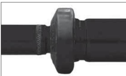
2. **VERBINDEN SIE DIE GEGENSTÜCKE:** Richten Sie die Mittellinien der beiden genuteten Gegenstückenden aufeinander aus. Führen Sie das kleinere Gegenstückende in die kleinere Öffnung der Dichtung und das größere Gegenstückende in die größere Öffnung der Dichtung ein, bis Kontakt mit dem Mittelsteg erfolgt. **HINWEIS:** Vergewissern Sie sich, dass kein Teil der Dichtung in die Nut eines der Gegenstücke hineinragt.
