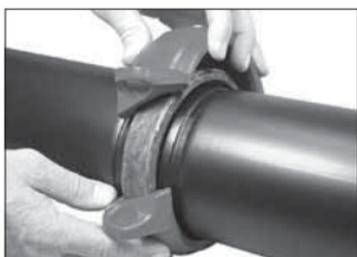
5. **BRINGEN SIE DIE GEHÄUSEHÄLFTEN AN:** Bringen Sie die Gehäusehälften über der Dichtung an. Stellen Sie sicher, dass die Federn der Gehäusehälften vollständig in die Nuten beider Gegenstücke eingreifen.
