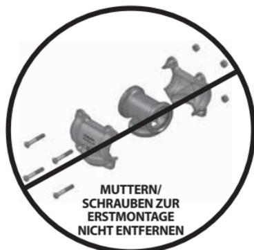
**1. NEHMEN SIE DAS FORMTEIL FÜR DIE ERSTINSTALLATION NICHT AUSEINANDER:** Die montagefertigen Victaulic® FireLock™ Installation-Ready™ Formteile Nr. 102 und 104 sind so konzipiert, dass der Monteur die Schrauben und Muttern für die Erstinstallation nicht entfernen muss. Dies erleichtert die Installation, da der Monteur das genutete Ende der Gegenstücke direkt in das Formteil einführen kann.
