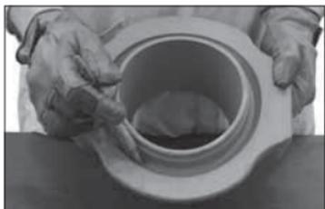
**4. SCHMIEREN SIE DIE NUT:** Tragen Sie eine dünne Schicht eines verträglichen Schmiermittels NUR an der O-Ringnut an der Unterseite des Zapfengehäuses auf. Siehe die Tabelle „Schmiermittelkompatibilität für Dichtungen“ auf Seite 34. Setzen Sie sich bezüglich der Schmiermittelkompatibilitätsanforderungen bei Verwendung des Typs 926 zusammen mit HDPE-Rohren immer mit dem Rohrhersteller in Verbindung.
