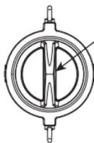
Richtige Ausrichtung für horizontalen Einbau
