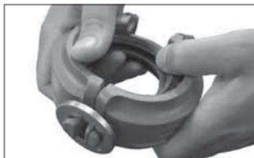
**7. BRINGEN SIE DIE ZWEITE KUPPLUNGSGEHÄUSEHÄLFTE UND DIE VERBINDUNG AN:** Bringen Sie die zweite Kupplungsgehäusehälfte an. Vergewissern Sie sich, dass die Dichtung in den Aussparungen der Gehäusehälften sitzt. Bringen Sie die Verbindung wie links abgebildet an den Gehäusehälften an.
