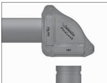
**5a. FÜHREN SIE DAS ZWEITE GEGENSTÜCKEIN:** Führen Sie das zweite genutete Gegenstückende in die zweite Öffnung des Formteils ein. Das genutete Gegenstückende muss so weit in das Formteil eingeführt werden, bis es mit dem Rohranschlag der Dichtung in Kontakt ist. Es ist eine Sichtprüfung erforderlich, um sicherzustellen, dass die Federn des Formteils mit der Nut im Gegenstückende fluchten.
