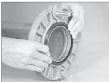
**7c.** Vergewissern Sie sich, dass die Flanschdichtung immer noch richtig in der Dichtungsaussparung des Typs 441 sitzt und dass die Beschriftung an der Flanschdichtung nicht sichtbar ist, wenn die Vorderseite des Typs 441 betrachtet wird.
