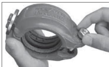
**8. BRINGEN SIE DIE SCHRAUBE UND MUTTER AN:** Bringen Sie die Schraube an und drehen Sie eine Mutter auf die Schraube. **HINWEIS:** Stellen Sie sicher, dass der ovale Hals der Schraube richtig im Schraubenloch sitzt. Ziehen Sie die Mutter NICHT ganz an. Für die erneute Montage der Kupplung müssen die Auflageflächen einen bestimmten Abstand haben. Die Mutter muss mit der Oberseite der Schraube bündig sein, um den richtigen Abstand zu gewährleisten.
