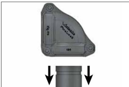
3. Stützen Sie das Formteil ab und lockern Sie die Mutter an der zweiten Stelle an der Außenseite des Formteils. Nehmen Sie das Formteil vorsichtig vom Gegenstück ab.
