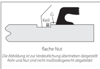
Wenn der Nutdurchmesser die Höchsttoleranz übersteigt, hat dies eine flache Nut zur Folge. Eine zu flache Nut hat dieselben Auswirkungen wie die Zustände, die im Abschnitt „Installationen mit zu kleinen Rohren/Formteilen“ oben beschrieben werden. Darüber hinaus kann durch diesen Zustand verhindert werden, dass an den Auflageflächen Kontakt von Metall auf Metall erzielt wird, was zum Lösen der Verbindung und zu Sachschäden führen kann.
