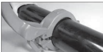
**4. RICHTEN SIE DIE LÖCHER AUS:** Drücken Sie das Montagewerkzeug fest nach unten, um die Gehäusehälften zusammenzubringen und die Löcher für den Arretierstift auszufluchten.
