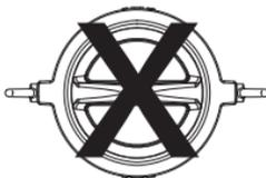
Falsche Ausrichtung für horizontalen Einbau
