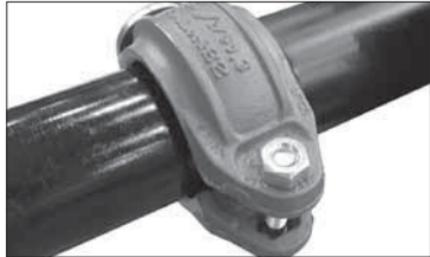
**4. STELLEN SIE DIE VERBINDUNG HER:** Stellen Sie die Verbindung her, indem Sie das genutete Ende eines Gegenstücks in jede Öffnung der Kupplung einführen. Die genuteten Gegenstückenden müssen so weit in die Kupplung eingeführt werden, bis sie mit dem Mittelsteg der Dichtung in Kontakt sind.
