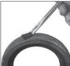
5. **SCHMIEREN SIE DIE DICHTUNG ZUM WIEDERZUSAMMENBAU VON KUPPLUNGEN DES TYPNS 009N, 107N UND 807N:** Tragen Sie eine dünne Schicht eines verträglichen Schmiermittels auf die Dichtlippen und die Außenseite der Dichtung auf. Siehe die Tabelle „Schmiermittelkompatibilität für Dichtungen“ auf Seite 34.
