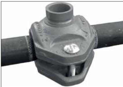
**4. STELLEN SIE DIE VERBINDUNG HER:** Stellen Sie die Verbindung her, indem Sie das genutete Ende eines Gegenstücks in die jeweilige Öffnung der Kupplung einführen. Die genuteten Gegenstückenden müssen so weit in die Kupplung eingeführt werden, bis sie mit dem Rohranschlag der Dichtung in Kontakt sind.
