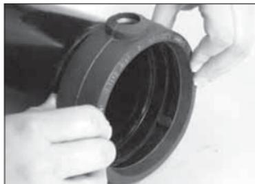
**2. BRINGEN SIE DIE DICHTUNG AN:** Bringen Sie die Dichtung so am Gegenstückende an, dass die Lippen an einer Seite den Bereich zwischen der Nut und dem Gegenstückende abdecken. **HINWEIS:** Das Gegenstückende darf nicht die Verstärkungsrippen in der Dichtung berühren.
