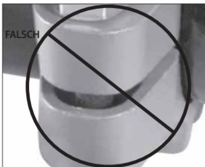
5. Führen Sie eine Sichtprüfung aller Auflageflächen an jeder Verbindung durch, um sicherzustellen, dass an den Auflageflächen überall Metall auf Metall trifft.
