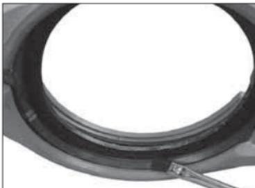
**4. SCHMIEREN SIE DIE DICHTUNG:** Tragen Sie eine dünne Schicht eines verträglichen Schmiermittels nur auf die Dichtlippen der Dichtung auf. Siehe die Tabelle „Schmiermittelkompatibilität für Dichtungen“ auf Seite 34. **HINWEIS:** Das Äußere der Dichtung ist werkseitig vorgeschmiert, so dass es nicht nötig ist, die Dichtung vom Gehäuse abzunehmen, um zusätzliches Schmiermittel auf ihre Außenfläche aufzutragen.
