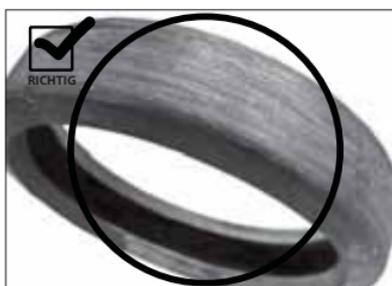
Richtig geschmierte Standarddichtung mit einer dünnen Schicht Schmiermittel
