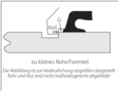
Wenn der AD des Rohrs oder des Formteils unterhalb der Mindesttoleranz liegt, verschlechtert sich der Eingriff des Federbereichs der Gehäusehälften erheblich. DARAUS RESULTIERT EIN VERRINGERTER BETRIEBSDRUCK AN DER VERBINDUNG.
