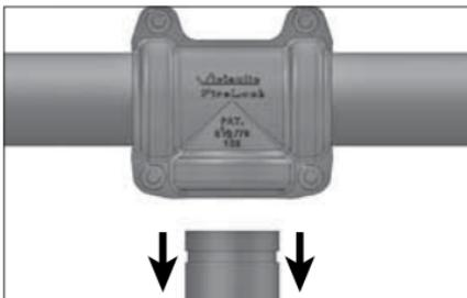
2. Lösen Sie die Schrauben nur entlang der Abzweigseite des Formteils (die Muttern sollten nicht über das Ende der Schrauben hinausragen). Nehmen Sie das Gegenstück von der gelockerten Abzweigseite ab. Vergewissern Sie sich, dass das Formteil am Gegenstück an den Durchgangsenden befestigt ist, damit es nicht herunterfällt.
