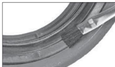
**3a.** Falls Umstände vorliegen, die in der „ANMERKUNG“ auf Seite 36 aufgeführt sind, tragen Sie eine dünne Schicht eines verträglichen Schmiermittels ausschließlich auf die Dichtlippen der Dichtung auf. Siehe die Tabelle „Schmiermittelkompatibilität für Dichtungen“ auf Seite 34.
