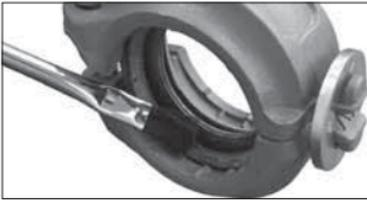
**3a.** Falls Umstände vorliegen, die in der „ANMERKUNG“ auf Seite 36 aufgeführt sind, tragen Sie eine dünne Schicht eines verträglichen Schmiermittels ausschließlich auf die Dichtlippen der Dichtung auf. Siehe die Tabelle „Schmiermittelkompatibilität für Dichtungen“ auf Seite 34.
