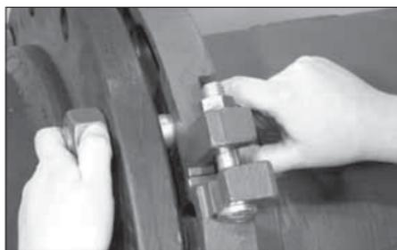
**9. VERBINDEN SIE 741 UND DEN GEGENFLANSCH:** Führen Sie die Montageschrauben, die in Schritt 8 angebracht wurden, in die Gegenflanschlöcher ein. Ziehen Sie auf jeder Schraube eine Mutter fest, damit die Schrauben nicht herausgezogen werden können.
