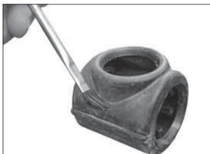
5. **SCHMIEREN SIE ZUM WIEDERZUSAMMENBAU VON AUSLASSKUPPLUNGEN DES TYP 118 DIE DICHTUNG:** Tragen Sie eine dünne Schicht eines verträglichen Schmiermittels auf die drei Dichtlippen und das Äußere der Dichtung auf. Siehe die Tabelle „Schmiermittelkompatibilität für Dichtungen“ auf Seite 34.
