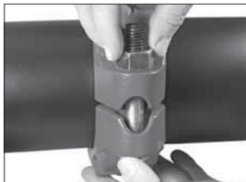
**4. BRINGEN SIE DIE GEHÄUSEHÄLFTEN AN:** Bringen Sie die Gehäusehälften über der Dichtung an. Stellen Sie sicher, dass die Federn der Gehäusehälften vollständig in die Nuten beider Gegenstücke eingreifen.
