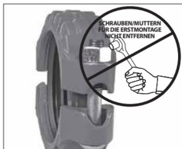
**1. NEHMEN SIE DIE KUPPLUNG NICHT AUSEINANDER:** Die flexiblen QuickVic™ Installation-Ready™ Kupplungen des Typs 177N und 877N sind so konzipiert, dass der Monteur die Muttern und Schrauben für die Installation nicht entfernen muss. Dies erleichtert die Installation, da der Monteur das genutete Ende der Gegenstücke direkt in die Kupplung einführen kann.
