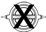
Orientamento non corretto per Installazione in orizzontale
