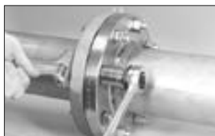
Schema di serraggio a 4 bulloni
