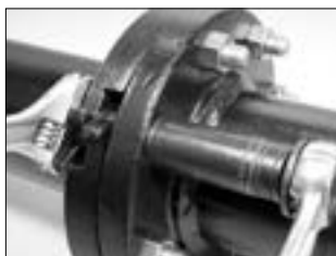
Schema di serraggio a 4 bulloni
