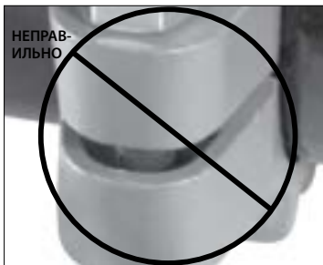
ОВАЛЬНЫЙ ПОДГОЛОВОК БОЛТА НЕ ЗАФИКСИРОВАН
