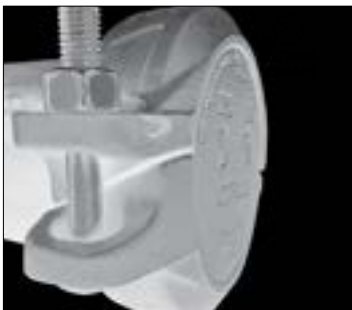
НЕПРАВИЛЬНАЯ СБОРКА (ДУЖКИ БОЛТОВ НЕ СОПРИКАСАЮТСЯ МЕТАЛЛИЧЕСКИМИ ПОВЕРХНОСТЯМИ)
