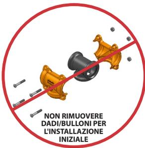
**1. NON SMONTARE IL RACCORDO PER LA PRIMA INSTALLAZIONE:** I raccordi n. 102 e 104 Victaulic® FireLock™ Installation-Ready™ sono progettati in modo che l'installatore non debba rimuovere dadi e bulloni per l'installazione. Questo facilita l'installazione consentendo all'installatore di inserire l'estremità scanalata dei componenti accoppiati nel raccordo.
