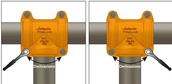
**5a. INSERIRE IL COMPONENTE ACCOPPIATO NELL'ESTREMITÀ DELLA DERIVAZIONE:** Inserire la terza estremità scanalata del componente accoppiato nell'apertura dell'estremità della derivazione. L'estremità scanalata del componente accoppiato deve essere inserita nel raccordo finché non sarà in battuta con il fermatubo della guarnizione. È necessario un controllo visivo per verificare che gli inserti del raccordo siano allineati con la scanalatura nel componente accoppiato.
