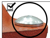
PRAWIDŁOWO OSADZONA OWALNA SZYJKA ŚRUBY
