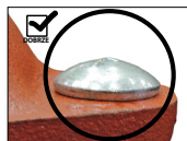
PRAWIDŁOWO OSADZONA OWALNA SZYJKA ŚRUBY
