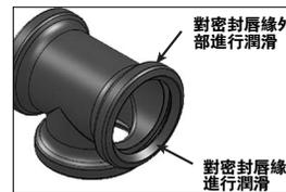
2. 潤滑尺寸正確的密封墊圈：如圖所示，在尺寸正確的密封墊圈的密封唇緣及其外部塗抹薄薄一層相容潤滑劑，如Victaulic (唯特利)潤滑劑或矽潤滑劑。
