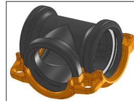
3. 將密封墊圈安裝到第一片管件殼體中：先將密封墊圈安裝到其中一片殼體中。如圖所示，確認密封墊圈兩端都完全嵌入殼體的凹槽中。
