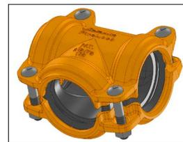
5. 安裝螺栓與螺母：安裝螺栓，在每個螺栓上擰上一個螺母。注：確認每個螺栓的橢圓頸正確位於螺栓孔中。請勿完全擰緊螺母。安裝螺栓座時需要留出一個間隙，以便進行管件的重新安裝。使螺栓從每個螺母中伸出兩整圈或三整圈螺紋即可提供適當的間隙。
