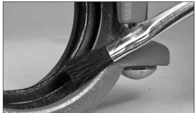
**4. SCHMIEREN SIE DIE DICHTUNG:** Tragen Sie nur auf die Dichtungslippen im Inneren der Dichtung eine dünne Schicht Victaulic Schmiermittel oder Silikonschmiermittel auf. **ANMERKUNG:** Das Äußere der Dichtung ist werksseitig mit einem Schmiermittel versehen, d.h., die Dichtung muss nicht aus dem Gehäuse entnommen werden, um zusätzliches Schmiermittel aufzutragen.
