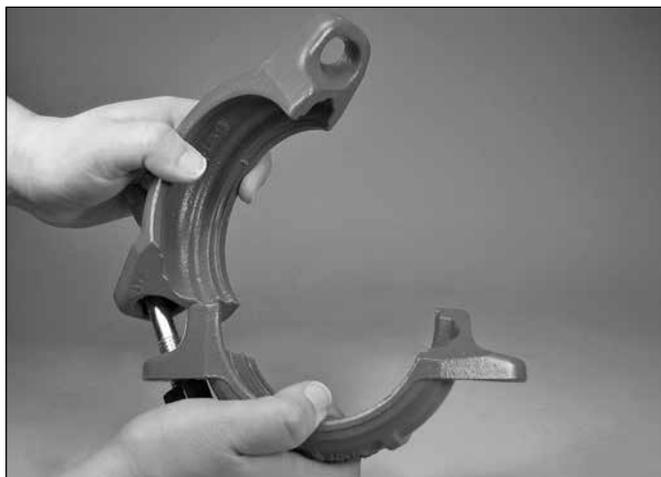
**6. ZUR ERLEICHTERUNG DER ERNEUTEN MONTAGE:** Eine Schraube kann in die Gehäusehälften eingeführt und die Mutter lose auf die Schraube gefädelt werden, damit die „Schwenkfunktion“, wie oben gezeigt, ermöglicht wird. **ANMERKUNG:** Die Mutter sollte nicht weiter rückwärts gedreht werden als bündig mit dem Schraubenende.
