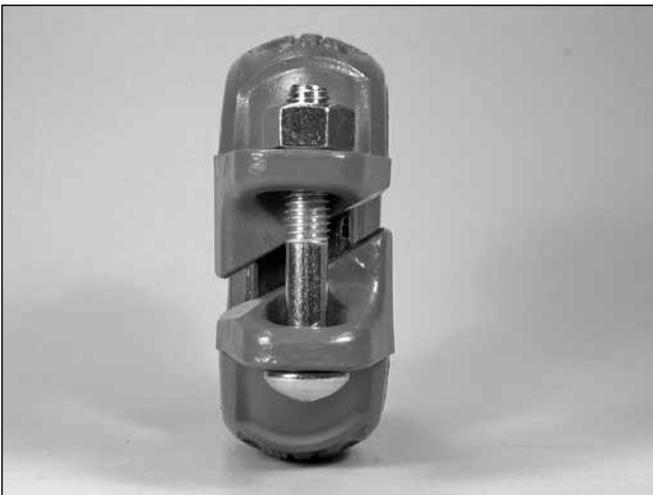
**1. DEMONTIEREN SIE DIE KUPPLUNG NICHT:** Die Kupplungen der Typen 107H/107N sind montagefertig. Diese Kupplungen sind so konstruiert, dass die Schrauben und Muttern zur Montage nicht entfernt werden müssen. So wird die Installation durch die direkte Montage der genuteten Rohrenden/Anschlusssteile in die Kupplung erleichtert.
