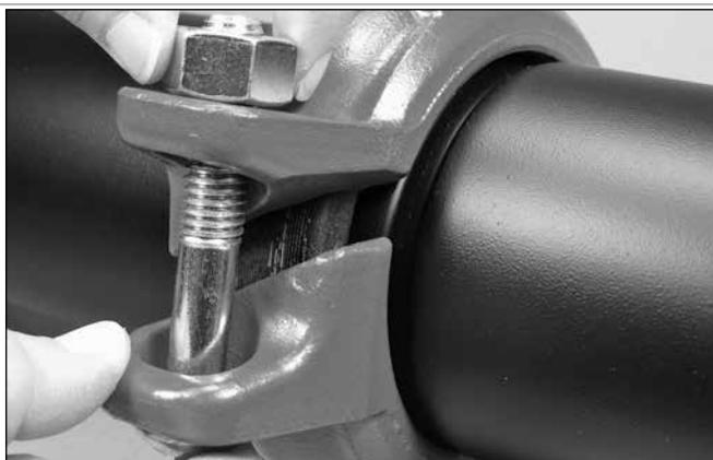
**8. MONTAGE DER VERBLEIBENDEN SCHRAUBE/MUTTER:** Montieren Sie die verbleibende Schraube und drehen Sie die Mutter von Hand auf die Schraube. **ANMERKUNG:** Stellen Sie sicher, dass die ovalen Schraubenhälse richtig in den Schraubenlöchern sitzen.
