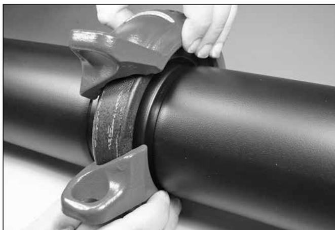
**7. GEHÄUSEHÄLFTEN MONTIEREN:** Montieren Sie die Gehäusehälften über der Dichtung. Vergewissern Sie sich, dass die Federn der Gehäusehälften richtig in die Nuten an beiden Rohren/Anschlussstellen einrasten.
