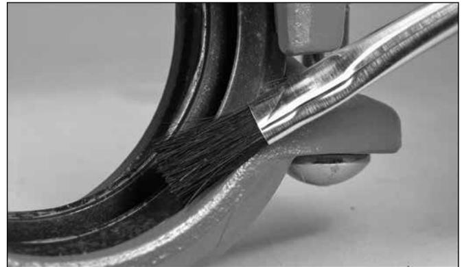
**4. LUBRIQUE LA EMPAQUETADURA:** Aplique una capa delgada de lubricante Victaulic o de silicona sólo a los labios de sello del interior de la empaquetadura. **NOTA: El exterior de la empaquetadura viene con lubricante aplicado en la fábrica, por lo que no hay necesidad de quitar la empaquetadura de los segmentos para aplicar más lubricante a la superficie exterior.**
