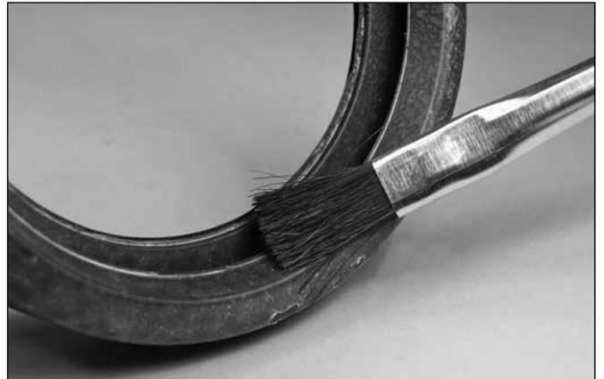
**3. PARA LA REINSTALACIÓN DE ACOPLES ESTILO 107H/107N, LUBRIQUE LA EMPAQUETADURA:** Aplique una capa delgada de lubricante Victaulic o lubricante de silicona a los labios de sello y al exterior de la empaquetadura. Es normal que la superficie de la empaquetadura tenga una apariencia blanca opaca después de que ha estado en servicio.
