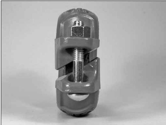
**1. NO DESARME EL ACOPLER:** los acoples Estilo 107H/107N vienen listos para su instalación. Estos acoples están diseñados de modo que el instalador no necesita quitar los pernos ni las tuercas en el montaje. Este diseño facilita la instalación porque permite al instalador insertar directamente el extremo ranurado de tubería o componentes acoplados en el acople.
