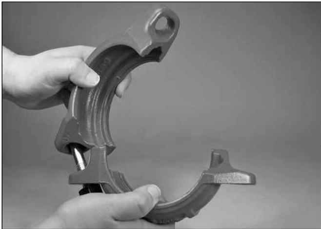
**6. PARA FACILITAR EL REENSAMBLE:** Se puede insertar un perno en los segmentos con la tuerca enroscada sin apretar para aprovechar la característica de "ensamble pivotante", como se muestra arriba. **NOTA:** La tuerca se debería aflojar sólo hasta que quede a ras con el extremo del perno.
