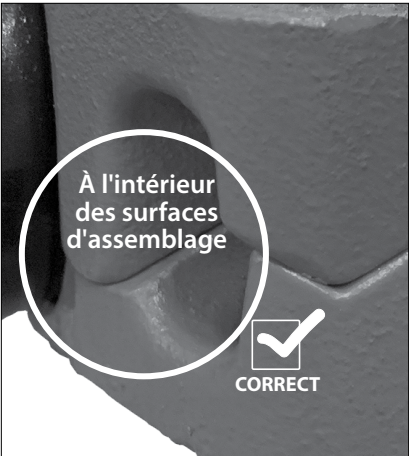
JOINT CORRECTEMENT ASSEMBLÉ CONTACT ENTRE LES SURFACES MÉTALLIQUES TEL QU'INDIQUÉ
