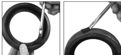
5. **PER RIASSEMBLARE I GIUNTI DI TIPO 107V, LUBRIFICARE LA GUARNIZIONE:** Per tutte le guarnizioni con codifica a colori, applicare un leggero strato di lubrificante compatibile sui labbri di tenuta della guarnizione e all'esterno. Fare riferimento alla tabella "Compatibilità lubrificante per guarnizioni" a pagina 1.
