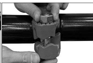
5. **INSTALLARE I GUSCI:** Installare i gusci sulla guarnizione. Verificare che gli inserti dei gusci si inseriscano completamente nelle scanalature di entrambi i componenti accoppiati.
