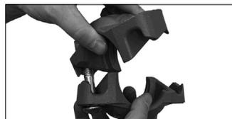
4. **PER SEMPLIFICARE IL RIASSEMBLAGGIO:** È possibile inserire un bullone nei gusci con il dado avvitato senza serrare sul bullone in modo da consentire la funzione di "oscillazione", come mostrato. **NOTA:** Il dado non deve essere filettato oltre il livello dell'estremità del bullone.
