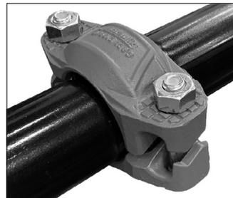
**4. MONTARE IL GIUNTO:** Montare il giunto inserendo l'estremità scanalata del componente accoppiato in ciascuna apertura del giunto stesso. L'estremità scanalata del componente accoppiato deve essere inserita nel giunto finché non si verificherà il contatto con il gambo centrale della guarnizione.
