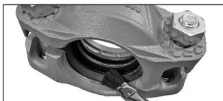
**3c. Per tutte le altre guarnizioni contrassegnate, comprese strisce rosse e verdi o strisce arancioni e argento:** Applicare un leggero strato di un lubrificante compatibile solo sui labbri di tenuta della guarnizione. Fare riferimento alla tabella "Compatibilità lubrificante per guarnizioni" riportata in seguito. **NOTA: Non è necessario rimuovere la guarnizione dai gusci per applicare lubrificante sulla superficie esterna.**
