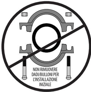
**1. NON SMONTARE IL GIUNTO:** I giunti rigidi tipo 107V QuickVic™ Installation-Ready™ sono progettati in modo che l'installatore non debba rimuovere dadi e bulloni per l'installazione. Questo facilita l'installazione consentendo all'installatore di inserire l'estremità scanalata dei componenti corrispondenti nel giunto dopo la corretta preparazione dell'estremità del componente di accoppiamento.
