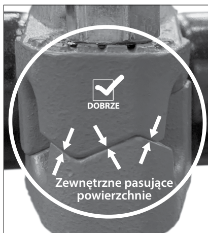
POŁĄCZENIE ZMONTOWANE PRAWIDŁOWO – POWIERZCHNIE METALOWE STYKAJĄCE SIĘ Z SOBĄ W POKAZANY SPOSÓB
