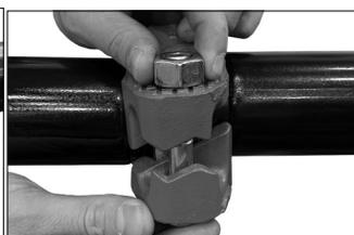
5. **INSTALAR LAS CARCASSAS:** Instale las carcassas sobre la junta. Asegúrese de que las patillas entren correctamente en las ranuras de ambos componentes a unir.
