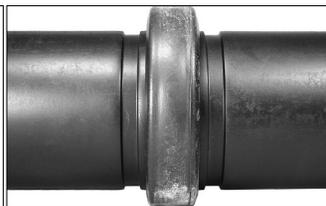
2. **INSTALAR LA JUNTA:** Introduzca el extremo ranurado del componente a unir en la junta hasta que entre en contacto con la patilla central de ésta.
