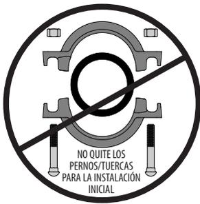
**1. NO DESMONTE EL ACOPLAMIENTO:** Los acoplamientos flexibles QuickVic™ Installation-Ready™ Estilo 107V están diseñados para que el instalador no tenga que quitar tuercas ni tornillos en la instalación inicial. Eso facilita la instalación al poder introducir directamente el extremo ranurado de los componentes en el acoplamiento adecuadamente preparado.
