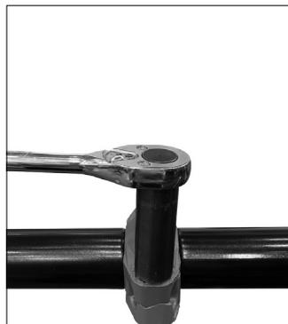
**5. APRIETE LAS TUERCAS:** Con una atornilladora o una llave de vaso profundo corriente, apriete las tuercas conforme a uno de los métodos explicados en la página 4. **NO** superar el “Par máximo admisible” de la tabla de la página 3 en cada tuerca. **NOTA:** En los acoplamientos que vienen con una etiqueta en los cierres de pernos, utilizar el método 2 (alternando los lados) explicado en la página 4.
