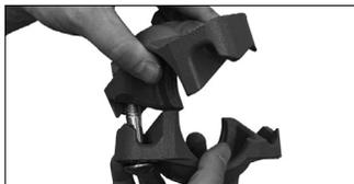
4. **PARA FACILITAR LA REINSTALACIÓN:** Puede introducir un perno en las carcassas y enroscar ligeramente la tuerca en el perno para pasarla por encima del tubo, como se muestra arriba. **NOTA:** La tuerca debe quedar enrasada con el extremo del perno.
