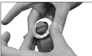
**7. INSTALE EL SEGUNDO SEGMENTO DEL ACOPLE Y EL ACCESORIO DE UNIÓN:** Instale el segundo segmento del acople. Verifique que la empaquetadura esté asentada en las cavidades de los segmentos. Instale el accesorio de unión en los segmentos, como se muestra a la izquierda.
