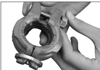
**8. INSTALE EL PERNO Y LA TUERCA:** Instale el perno y enrosque una tuerca en él. **NOTA:** Verifique que el cuello oval del perno se asiente correctamente en el orificio para el perno. NO apriete la tuerca por completo. Los cierres empernados deben ajustarse con una separación que permita reinstalar el acople. La tuerca debería quedar rasa con la parte superior del perno para lograr una separación adecuada.
