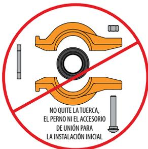
**1. NO DESARME EL ACOPLE:** Los acoples Estilo 108 están diseñados de tal manera que el instalador no necesita retirar la tuerca, el perno o la articulación para la instalación inicial. Esto facilita el montaje al permitir que el instalador inserte directamente el extremo ranurado del componente acoplado en el acople.
