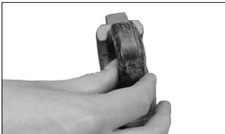
**6. INSTALE LA EMPAQUETADURA EN EL SEGMENTO DEL PRIMER ACOPLE:** Instale la empaquetadura en uno de los segmentos. Verifique que la empaquetadura esté asentada completamente en la cavidad del segmento.
