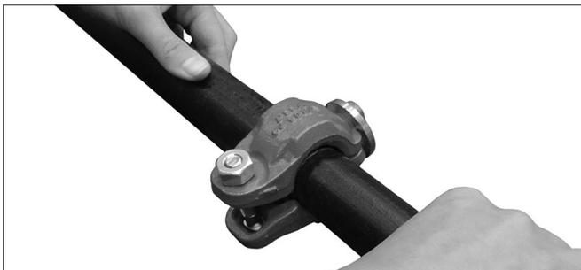
**4. ENSAMBLE LA UNIÓN:** Ensamble la unión insertando el extremo ranurado de un componente acoplado en cada abertura del acople. Los extremos de los componentes acoplados ranurados se deben insertar en el acople hasta obtener contacto con el soporte central de la empaquetadura.
