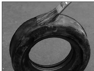
**5. PARA REINSTALAR LOS ACOPLES ESTILO 108, LUBRIQUE LA EMPAQUETADURA:** Aplique una capa delgada de lubricante compatible a los labios de sello de la empaquetadura y al exterior. Consulte la tabla "Compatibilidad de lubricantes para empaquetaduras" en la página 2.
