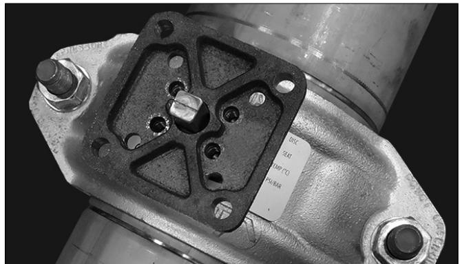
7. Bringen Sie die Adapterplatte für den Antrieb über dem Schaft an. Richten Sie die Löcher in der Adapterplatte für den Antrieb mit den Löchern im Flansch aus.
