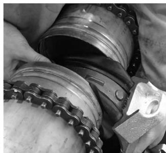
3. Während Sie die Oberseite der Armaturenbaugruppe sicher abstützen, drücken Sie die Dichtung zwischen den Gegenstückenden ein. Drücken Sie die Dichtung weiter zwischen den Gegenstückenden ein, während Sie die Armaturenbaugruppe durch die Öffnung zwischen den Gegenstückenden schieben.
