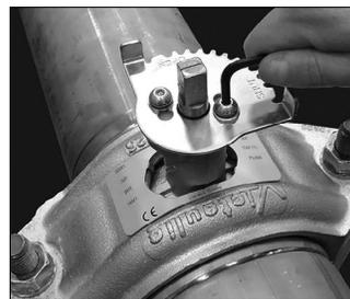
4. Nehmen Sie die beiden Kopfschrauben und Unterlegscheiben und dann die Rasterhebelplatte ab.
