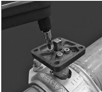
3. Tragen Sie ein Gewindegewand auf die Kopfschrauben auf. Setzen Sie die Kopfschrauben ein, um die Antriebsadapterplatte am Flansch zu befestigen. **Ziehen Sie jede Kopfschraube auf 28 – 30 ft-lbs/ 38 – 41 N•m an.**
