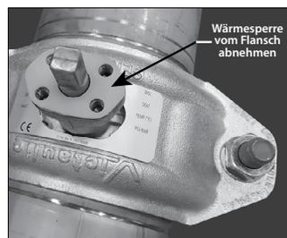
5. Nehmen Sie die Wärmesperre vom Flansch ab.
