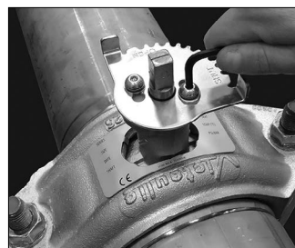
4. Ta bort de två bultarna och brickorna och ta sedan bort den låsbara spakens platta.
