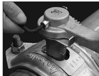
2. Quite el tornillo de ajuste del lateral de la palanca de bloqueo.
