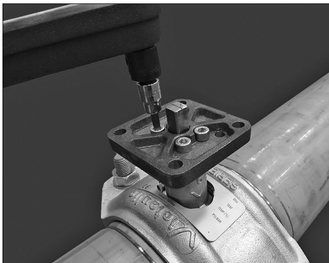
8. Montați componenta de blocare prin filetare pe șuruburile opritoare. Introduceți șuruburile opritoare pentru a fixa placa adaptoare pentru roata de manevră pe flanșă. Strângeți fiecare șurub opritor la 28 – 30 ft-lbs/38 – 41 N·m.
