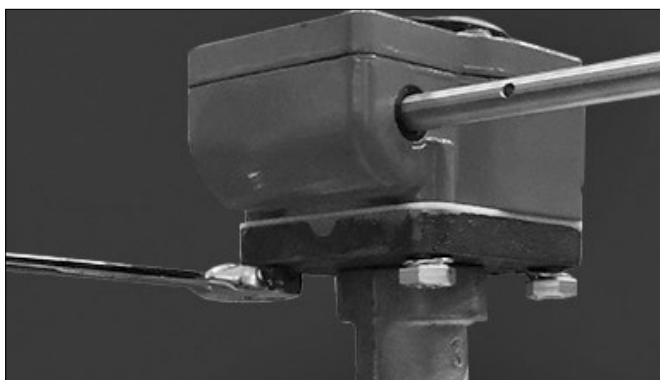
12a. Așezați ansamblul format din bușa de antrenare/roata de antrenare pe placa adaptoare pentru roata de manevră aliniind cele patru orificii ale roții de manevră cu cele patru orificii de pe placa adaptoare pentru roata de manevră/bariera termică. NOTĂ: În anumite situații, poate fi necesară rotirea roții de mână pentru a poziționa bușa de antrenare/tija pentru a alinia modelele orificiilor pentru șuruburi ale roții de manevră și plăcii adaptoare pentru roata de manevră. În acest caz, slăbiți piulița hexagonală de blocare și șurubul de fixare intern al limitatorului de cursă „închis” pentru a permite alinierea (consultați pagina următoare).
