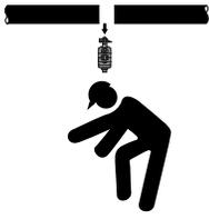
• No deje nunca montada a medias en el componente una válvula mariposa Installation-Ready™. **APRIETE SIEMPRE LA TORNILLERÍA INMEDIATAMENTE, TAL Y COMO SE DESCRIBE EN LAS INSTRUCCIONES DE INSTALACIÓN.** Una válvula montada a medias supone un peligro de goteo durante la instalación o de explosión durante las pruebas.
