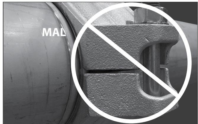
6. Inspeccione visualmente que haya contacto metal con metal en todos los cierres de pernos, conforme al paso 5 de la página 3.
