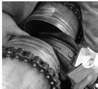
3. Mientras sujeta firmemente la parte superior del conjunto de válvula, apriete la junta entre los extremos del componente a unir. Continúe metiendo la junta entre los extremos del componente a unir mientras empuja el conjunto de válvula a través de la abertura entre los extremos del componente a unir.
