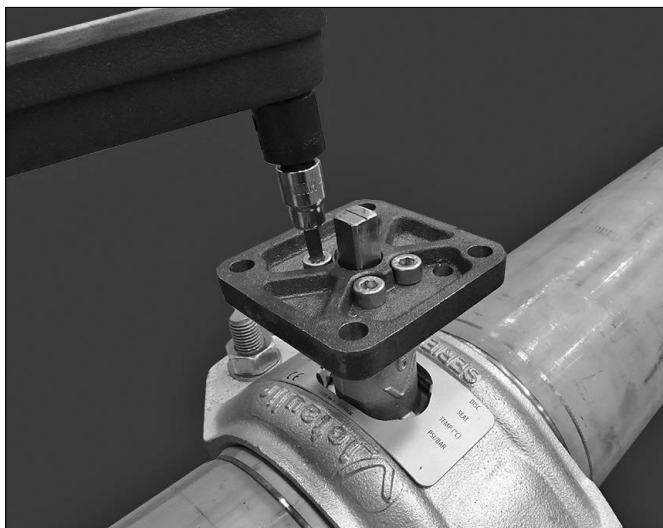
8. Applicera gänglåsning på hålskruvarna. Sätt i de fyra bultarna som fäster manöverdonets adapterplatta på flänsen. Dra åt skruvarna till 38 – 41 N•m.
