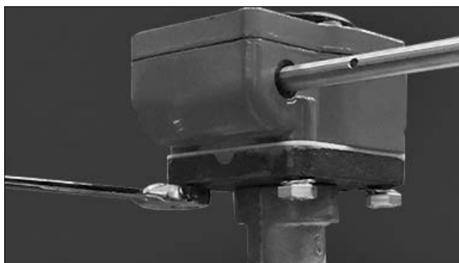
12a. Placera manöverdonet/drivbussningen på manöverdonets adapterplatta och passa in de fyra hålen på manöverdonet mot de fyra hålen i manöverdonets adapterplatta/termoskydd.
