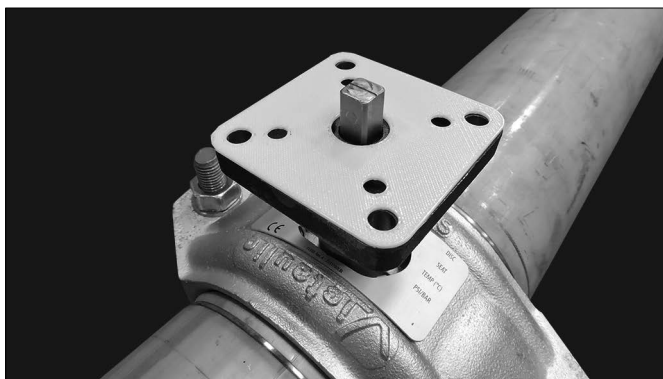
9. Trä termoskyddet på spindeln. Passa in hålen i termoskyddet mot hålen i manöverdonets adapterplatta.
