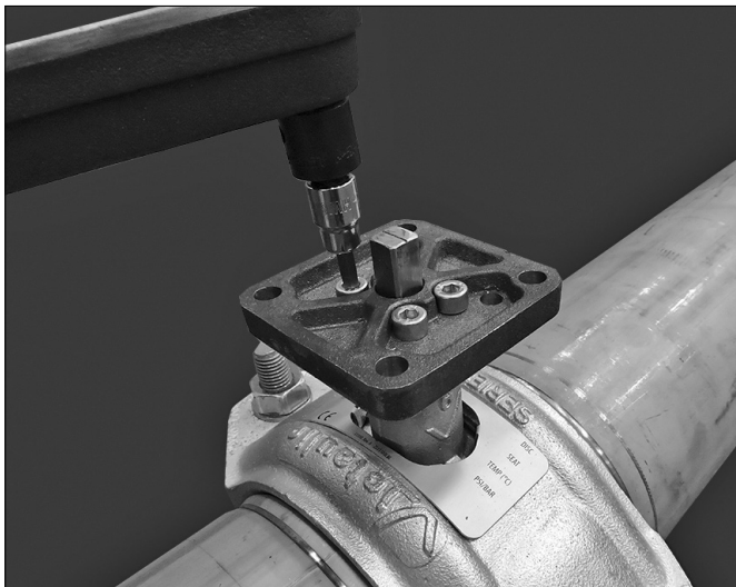
8. 在有頭螺絲上塗抹螺紋防鬆劑。插入有頭螺絲，將齒輪操作機構轉接板固定到法蘭上。將每個有頭螺絲栓緊至28 – 30英寸·磅/38 – 41牛·米扭矩。
