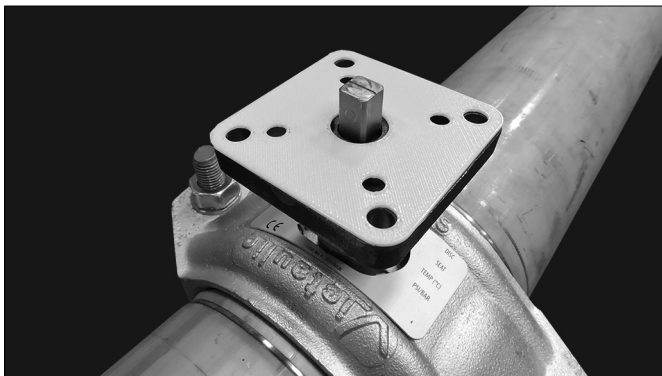
9. 將熱障放到閥杆上。將熱障的螺栓孔對準齒輪操作機構轉接板的螺栓孔。
