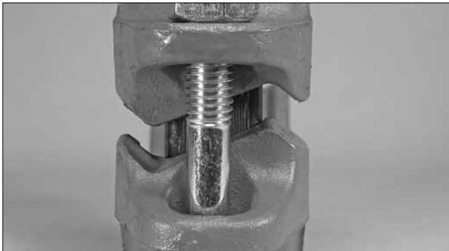
**1. NO DESARME EL ACOPLER:** Los acoples Estilo 177 vienen listos para instalar. El acople está diseñado para que el instalador no tenga que quitar los pernos ni las tuercas. Este diseño facilita la instalación ya que permite que el acople se instale directamente al extremo ranurado de la tubería o de los componentes acoplados.
