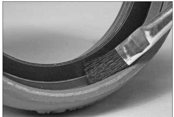
**4. LUBRIQUE LA EMPAQUETADURA:** Aplique una capa delgada de Lubricante Victaulic o lubricante de silicona sólo a los labios de sello del interior de la empaquetadura. **NOTA: El exterior de la empaquetadura viene con un lubricante aplicado en la fábrica, por lo que no es necesario quitar la empaquetadura de los segmentos para aplicar más lubricante a la superficie exterior.**
