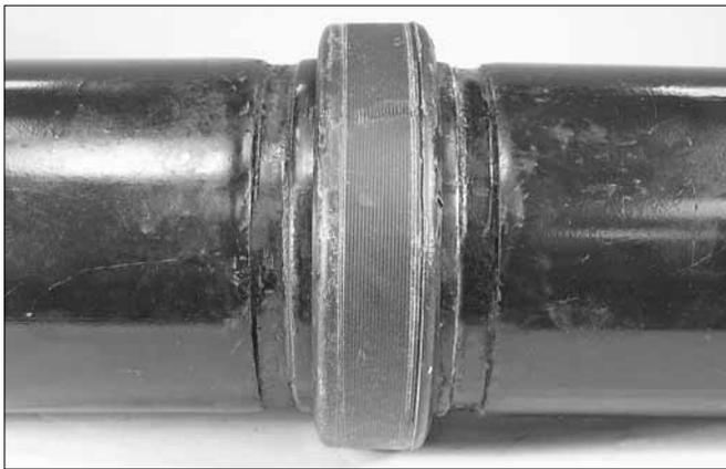
**5. UNA LOS EXTREMOS DE LA TUBERÍA O EL COMPONENTE ACOPLADO:** Alinee los dos extremos ranurados de la tubería o del componente. Inserte el otro extremo de la tubería o del componente en la empaquetadura hasta que tope con la pata central de la misma.
