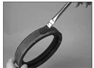
**3. PARA LA REINSTALACIÓN DE ACOPLES ESTILO 177, LUBRIQUE LA EMPAQUETADURA:** Aplique una capa delgada de Lubricante Victaulic o lubricante de silicona a los labios de sello y al exterior de la empaquetadura. Es normal que la superficie de la empaquetadura tenga una apariencia blanca nebulosa después de que ha estado en servicio.
