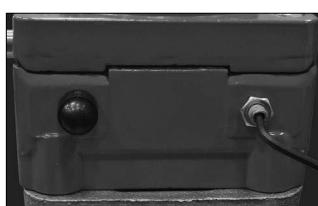
4a. Ziehen Sie die innen liegende Stellschraube mit einem Inbusschlüssel (im Uhrzeigersinn) so lange an, bis sie mit dem internen Quadrantengetriebe in Kontakt kommt.
