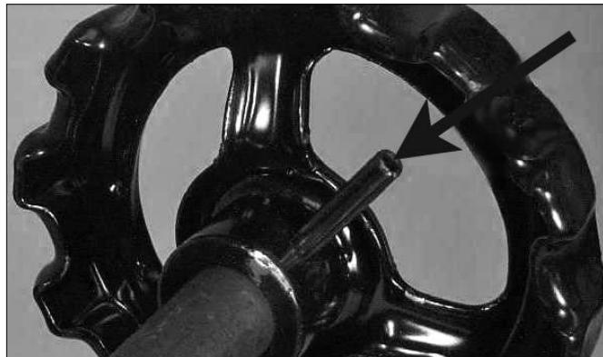
**HINWEIS:** Bei 10-Zoll/DN250- und 12-Zoll/DN300-Absperrklappen der Serie 250 ist das Handrad nicht an der Welle befestigt. Um das Handrad an der Welle zu befestigen, richten Sie die Löcher im Handrad an den Löchern in der Welle aus. Treiben Sie den Spannstift (mitgeliefert/am Handrad befestigt) vollständig in das Handrad und die Welle.
