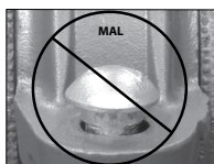
CUELLO OVAL DEL PERNO ASENTADO INCORRECTAMENTE
