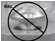
CUELLO OVAL DEL PERNO ASENTADO INCORRECTAMENTE
