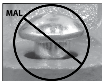
CUELLO OVAL DEL PERNO ASENTADO INCORRECTAMENTE
