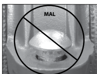
CUELLO OVAL DEL PERNO ASENTADO INCORRECTAMENTE
