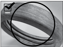
Empaquetadura correctamente lubricada con una capa delgada de lubricante
